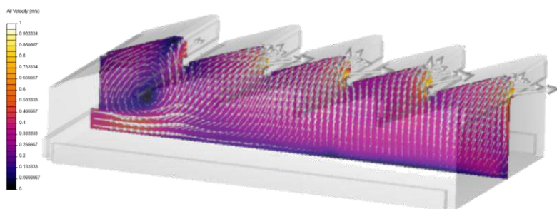
(ESQ) Simulação de ventilação natural para determinar os fluxos de ar na edificação por Ca2.
